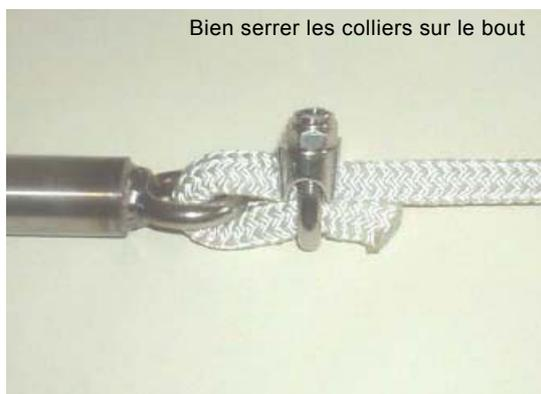
Raccordement du bout à la turbine Fig. 5
