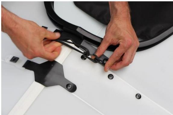
Accrochez les clips (ceux avec l'élastique qui servent aussi à maintenir le kayak plié) devant et derrière le cockpit dans les oeillets.
