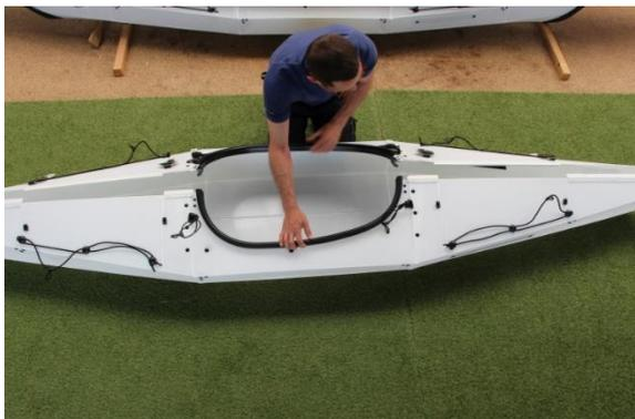
Rassemblez les deux bords et reliez les filets de pont pour l'instant uniquement à l'aide des clips situés près du cockpit.
