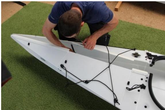
Passez la main à l'intérieur de la proue pour y positionner une baguette. Faites de même à la poupe avec la deuxième baguette.
