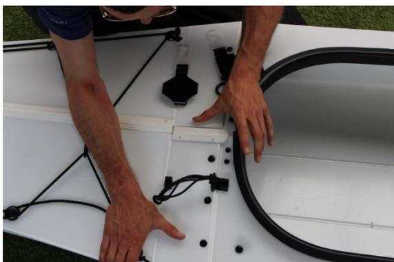
En règle général, la tâche est plus facile si vous commencez par les sections partant du cockpit pour aller vers les pointes. Commencez par assembler la courte section de rail juste devant (respectivement derrière) le cockpit avec la section suivante.
