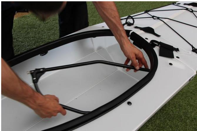
Le couple arrière (plus aplati) s'installe de la même manière. D'abord les deux supports des côtés, puis le haut qui vient se fixer sur le support depuis l'intérieur.
