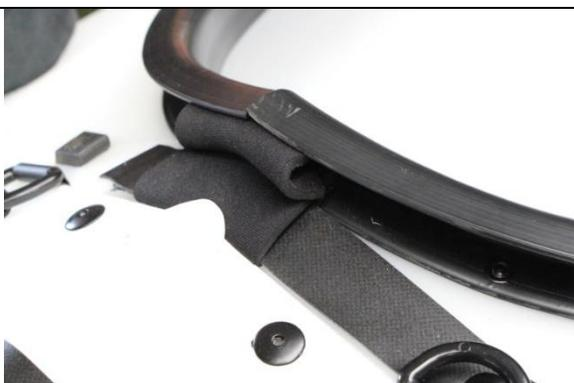
Enroulez la tige en néoprène, qui se trouve au niveau des rabats juste devant et derrière le cockpit, sous le rebord du cockpit (sous l'hiloire)
