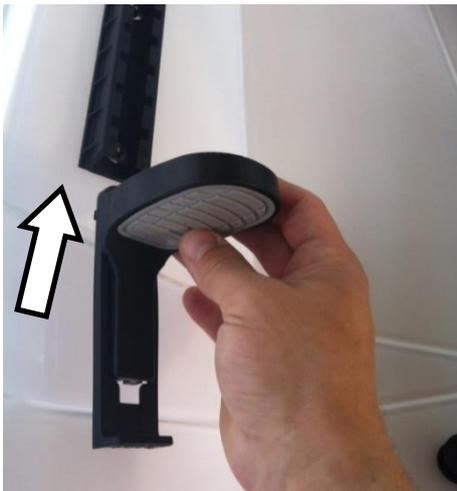
Faites glisser le cale-pied sur le rail pré-installé dans le kayak.
