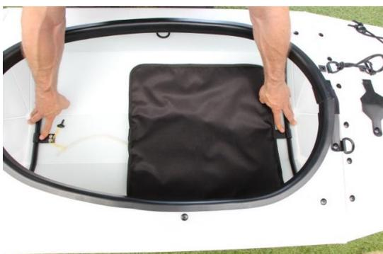
Veillez à fixer les crochets en C à l'avant et à l'arrière sur les couples du cockpit.
